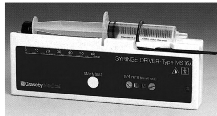
Пример шприцевого инфузионного насоса (инфузомата), описанного выше
