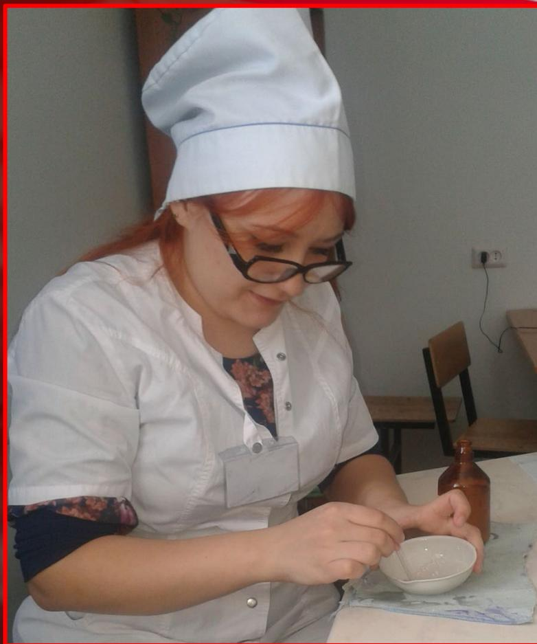
0,2 г. препарата помещают в фарфоровую чашку, перемешивают с 0,5 мл. конц. серной кислоты и 1-2 каплями воды; ощущается запах уксусной кислоты.
